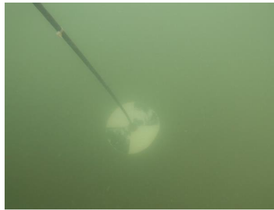
Station Centre : Mesure de la turbidité, 145 cm
