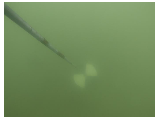
Station Salaison : mesure de la visibilité (100 cm).
