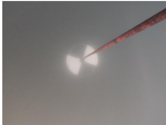
Station Gr Travers : Mesure de la visibilité (140cm), sans toutefois atteindre le fond lagunaire
