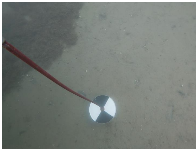
Station Gr Travers : Mesure de la visibilité. Fond observé (130cm) : Sédiments et tapis d'algues
