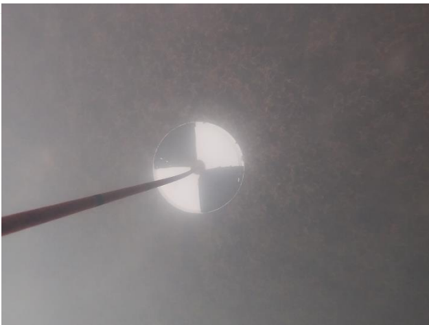
Station Bastit : Mesure de la visibilité, fond observé (70cm). Tapis de macro algues rouges.
