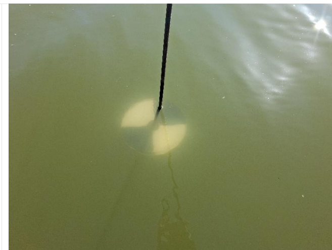
Station Carnon : Vue générale depuis le bateau, visibilité à 80 cm.
