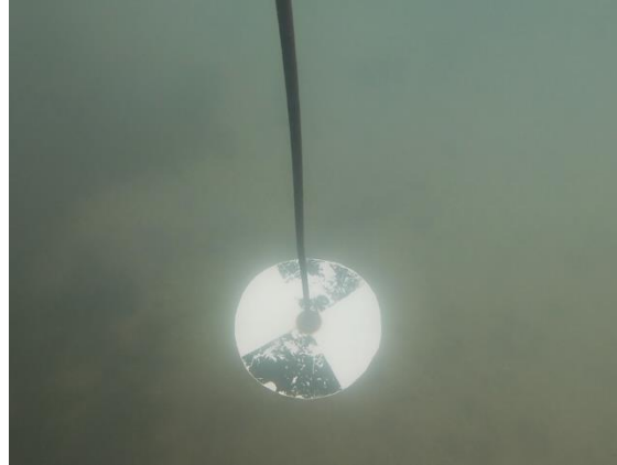
Station Canon : transparence de l'eau, déterminée par le protocole du « disque de Secchi »
