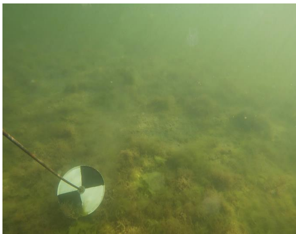
Station Gr Travers : mesure de la visibilité (110 cm). Fond observé : tapis d'algues.
