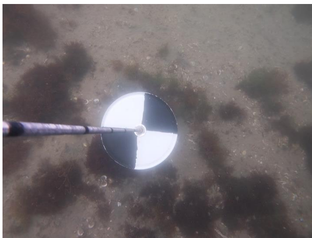
Station Gr Travers : mesure de la visibilité (100 cm) fond observé. Algues rouges et sédiments.
