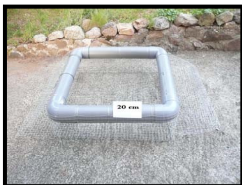
Photo 9 : piège à insolation simple de Corse (source : Julie Peinado)
